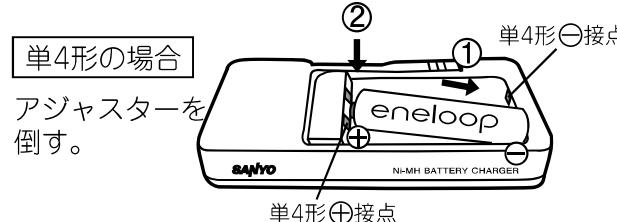
**外しかた** 電池の $\oplus$ 側を $\ominus$ 方向へ押し込みながら $\oplus/\ominus$ 側を $\ominus$ 接点から外してください。
